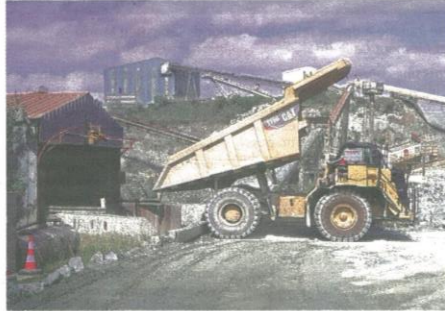
Les « dumpers » transportent la pierre jusqu'à l'usine où elle sera transformée.
